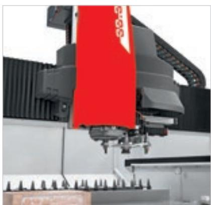
Almacén a bordo del cabezal giratorio de 8 posiciones para reducir los tiempos de sustitución de las herramientas utilizadas más frecuentemente.
