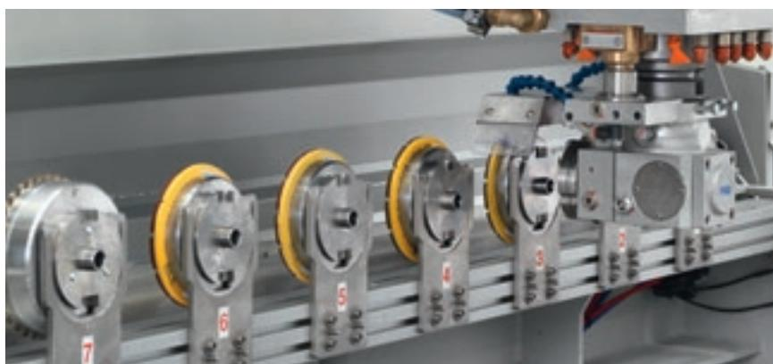
Almacén dedicado al cambio herramienta para agregado con cambio magnético.
