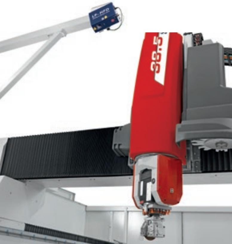
El proyector láser se utiliza para facilitar y acelerar la preparación de la zona de trabajo reproduciendo en la superficie de trabajo la posición de todas las ventosas y piezas de trabajo y evitar el movimiento del cabezal.
