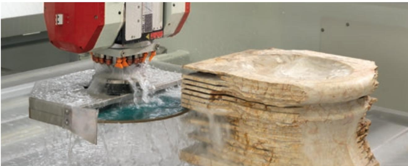
Corte con disco con cualquier inclinación.
