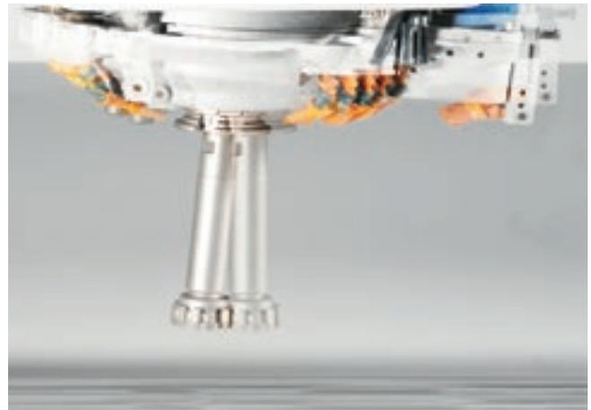
Eje T basculante ( $\pm 2,5^\circ$ ) para la realización de perfiles rebajados con plano inclinado para encimeras de cocina.
